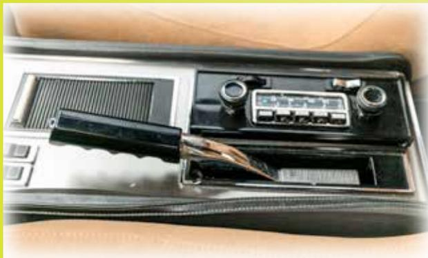
**E**n Allemagne, les SM étaient principalement livrées d'usine avec des radios Blaupunkt, de type Francfort ou Cobourg. Les modèles Blaupunkt-Cobourg disposaient d'un bouton de recherche automatique de stations. Cependant, aucun d'entre eux n'a été adapté à la conception verticale de la SM et présentait plutôt une disposition d'affichage horizontal classique. Pour la SM, une plaque de montage spéciale a été utilisée, aujourd'hui difficile à trouver.
