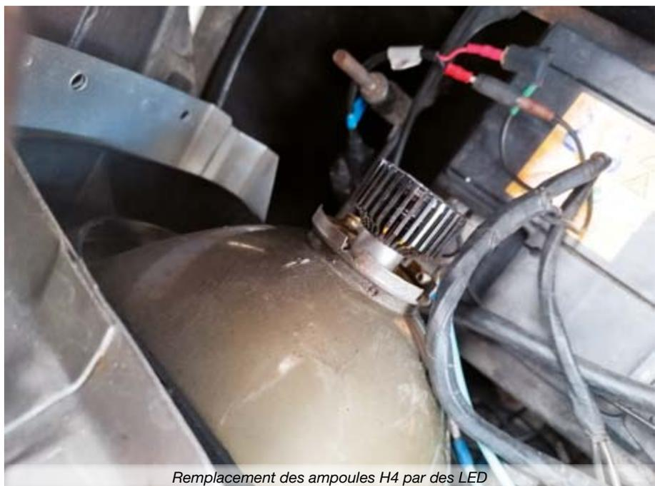
*Remplacement des ampoules H4 par des LED*
